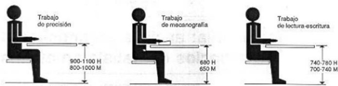
Figura 34. Altura del plano de trabajo para puestos de trabajo sentados Fuente: Instituto Nacional de Seguridad e Higiene en el Trabajo (INSHT)
