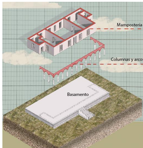
Imagen 08: Estructura base, mampostería y columnas
