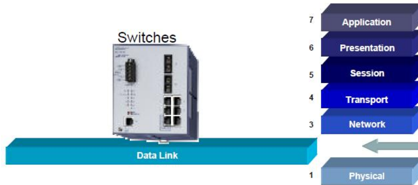
Gráfico 57: Equipos de capa de enlace
