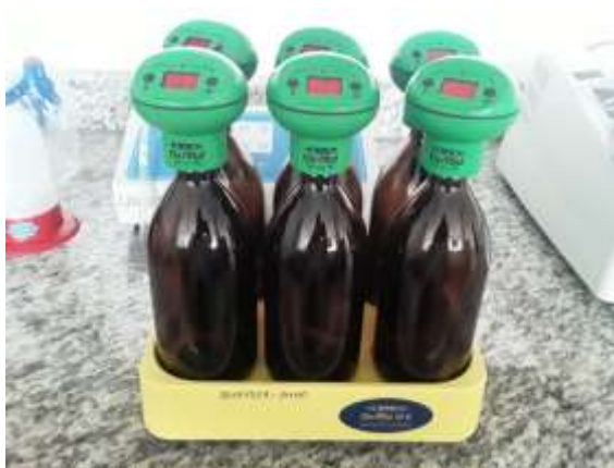
Figura 15. Determinación de la Demanda Bioquímica de Oxígeno se determinó mediante el equipo OxiTop.
