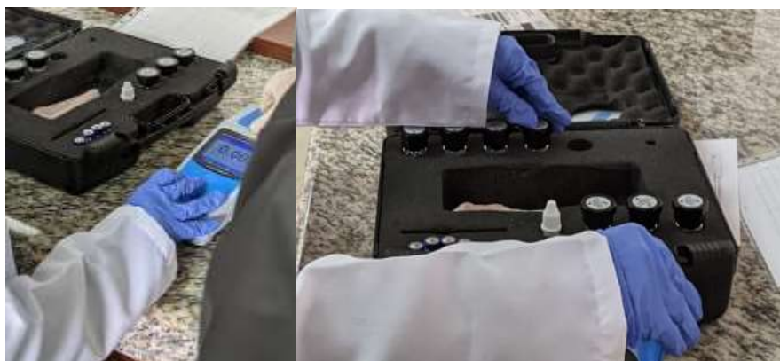
Figura 12. Medición de la turbidez utilizando el turbidímetro portátil TN400 TURBIDITY
