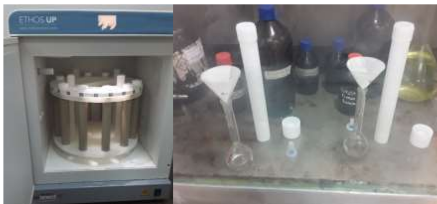
Figura 10. Medición de metales pesados utilizando en Digestor microondas ETHOS UP MILESTONE.
