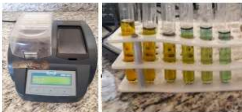
Figura 14. Determinación de la Demanda Química de Oxígeno (DQO) mediante espectrofotómetro HACH
