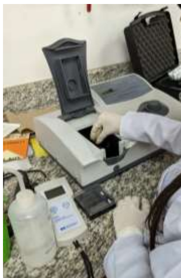
Figura 18. Determinación de sulfatos mediante el Test Sulfatos de la marca MERCK.
