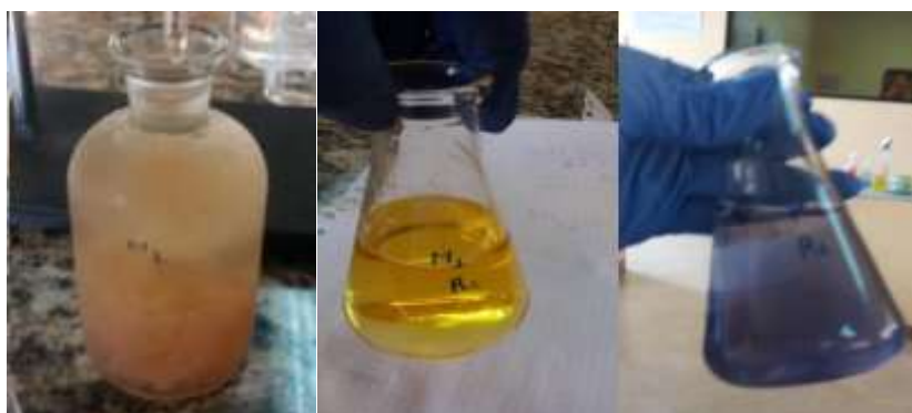
Figura 13. Determinación de Oxígeno Disuelto mediante método yodométrico
