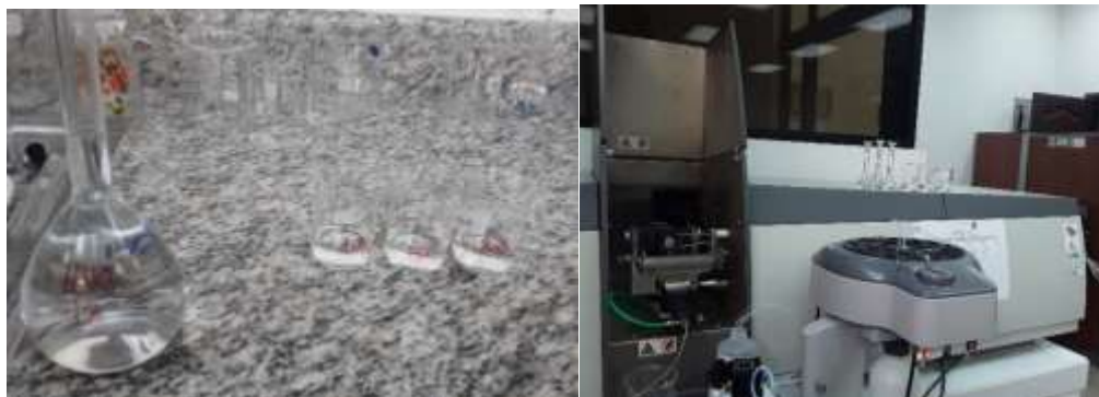
Figura 11. Medición de metales pesados Mediante el Espectrofotómetro de Absorción Atómica PG INSTRUMENTS AA500 con horno de grafito
