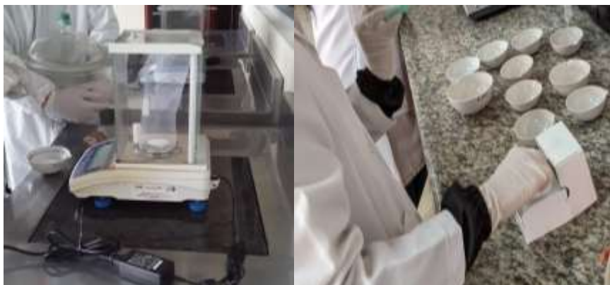
Figura 17. Determinación de sólidos disueltos totales por método gravimétrico
