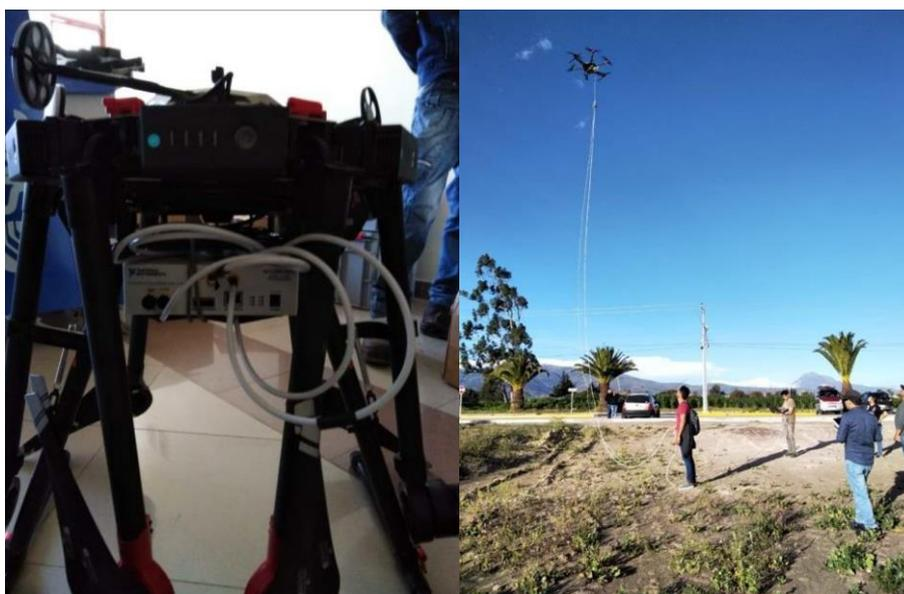
Fig. 16 a) USRP y antena montada en dron Matrice 600 b) Dron en vuelo para pruebas de funcionamiento en campo en zona rural.
