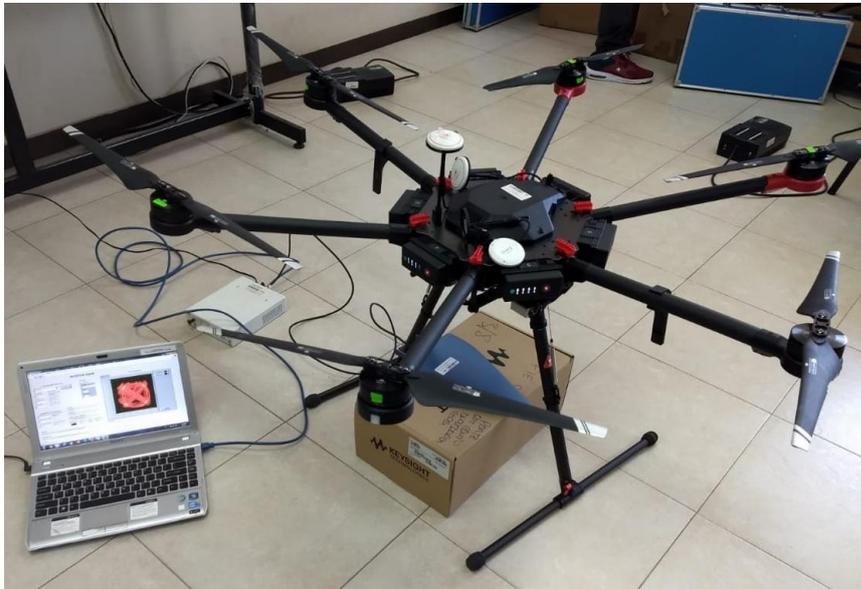
Fig. 14 Pruebas de funcionamiento en laboratorio con antena log periódica y dron Matrice 600 en funcionamiento.
