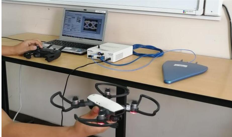
Fig. 13 Pruebas de funcionamiento en laboratorio con antena log periódica y dron en funcionamiento.
