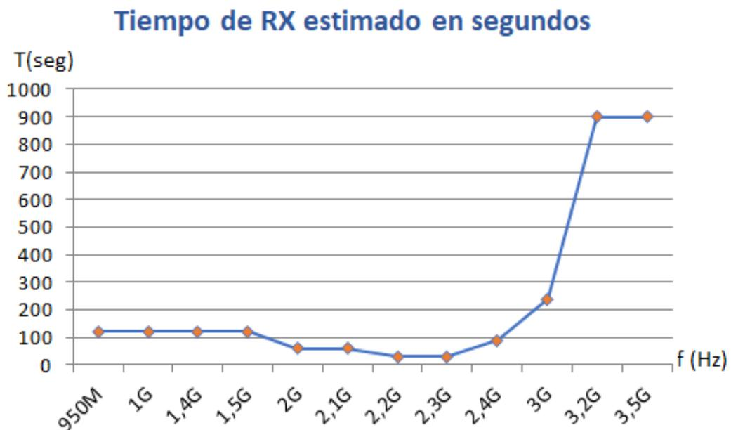
**Fig. 24 Resultados obtenidos de las pruebas de funcionamiento en ambiente de laboratorio. Tiempo de recepción estimado en segundos**
