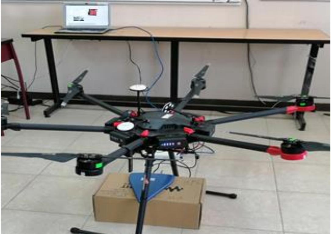
**Fig. 23 Pruebas de funcionamiento con antena logo periódica y dron en funcionamiento.**
