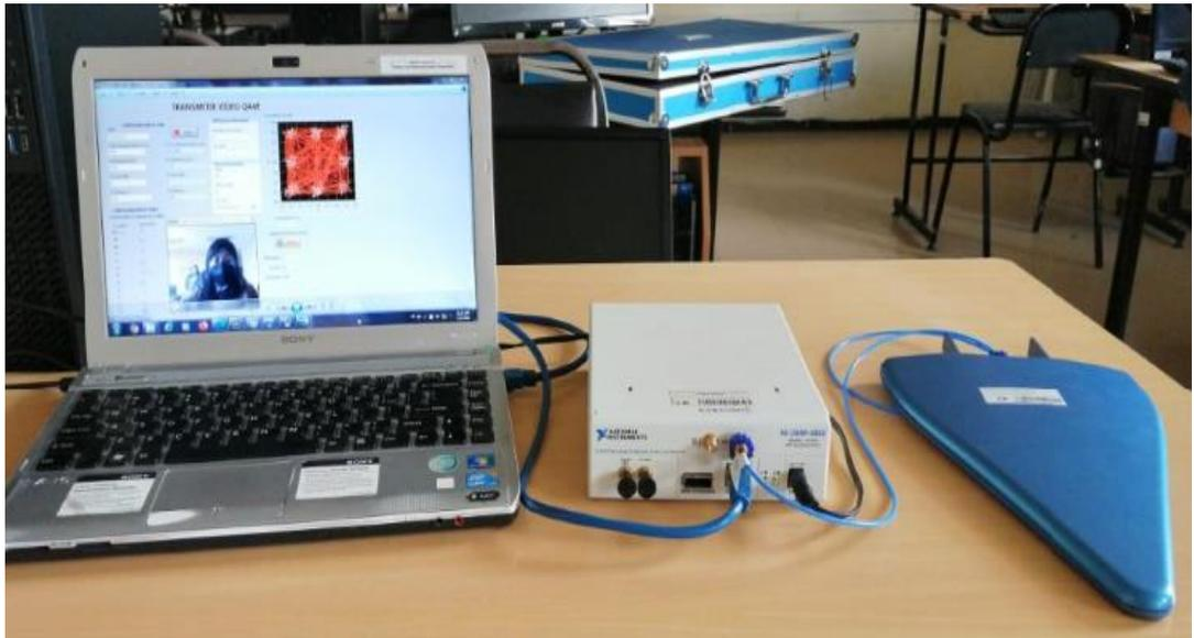
**Fig. 21 Pruebas de funcionamiento con antena log-periódica Transmisor**
