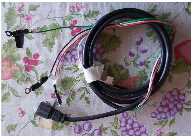
Figura 4.35: Cable de AC del Gateway PLC
