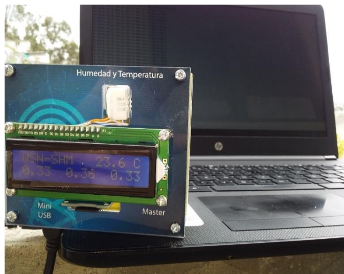
Figura 4.19: Encendido y verificación de la comunicación de la Red WSN
