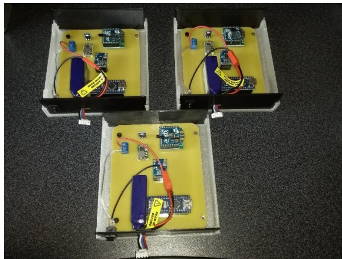
Figura 4.12: Elaboración de las placas de los Nodos Terminales
