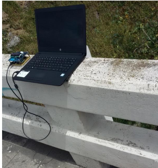
Figura 4.18: Montaje del nodo coordinador “Estación Base”
