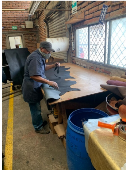
Figura 13 Saneado de bandas terminadas
