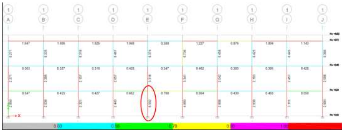
Figura 54: Demanda-Capacidad en columnas - cargas sísmicas - Eje 1.
