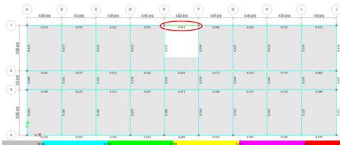
Figura 101: Demanda-Capacidad en vigas - cargas sísmicas – Nivel 3.24.
