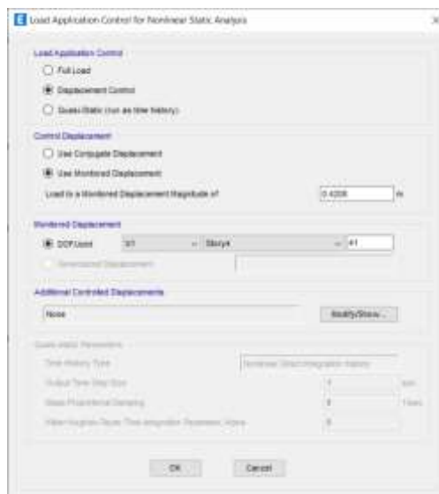
Figura 63: Definición de límite de desplazamiento y nodo de control.
