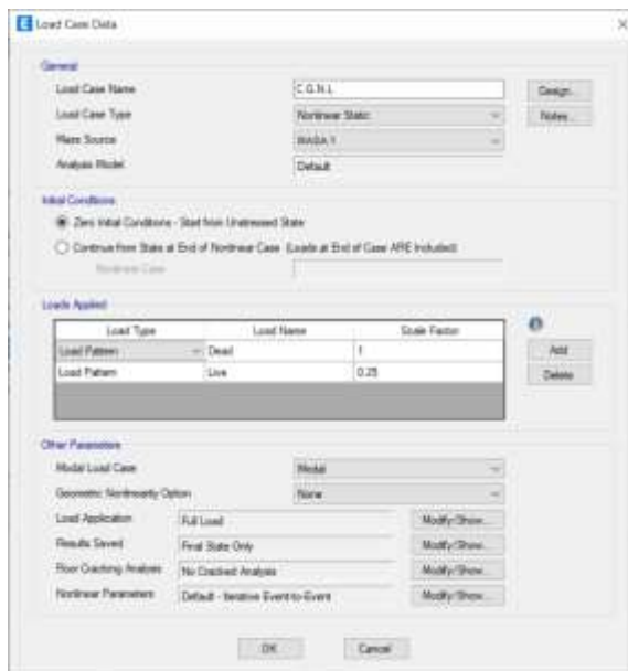
Figura 61: Definición de la Carga Gravitacional No Lineal.
