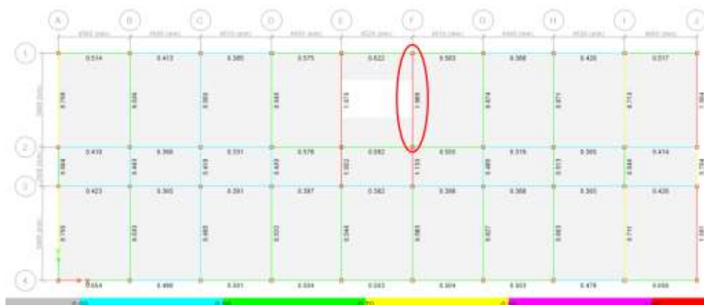
Figura 55: Demanda-Capacidad en vigas - cargas sísmicas – Nivel 3.24.
