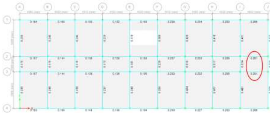
Figura 51. Demanda Capacidad en vigas - cargas gravitacionales Nv+6.48.
