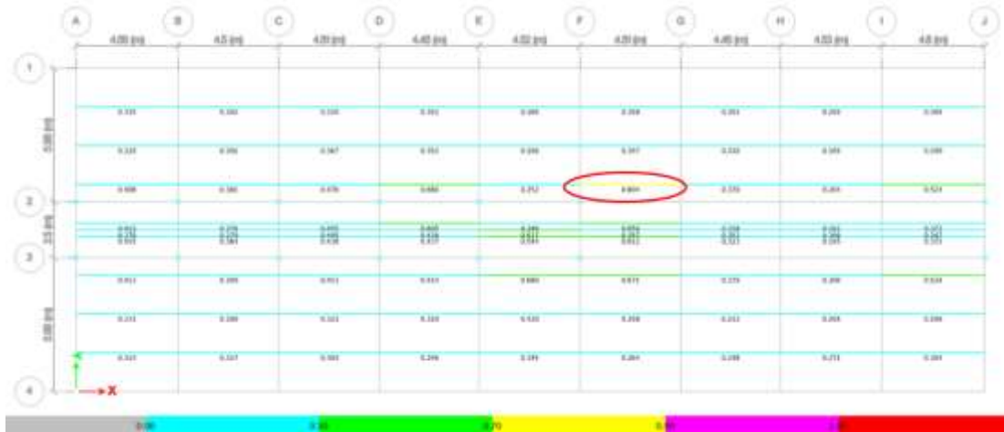
Figura 56: Demanda-Capacidad en correas - cargas sísmicas.
