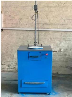
**Figura 2.9.** Máquina para pruebas de impacto.
