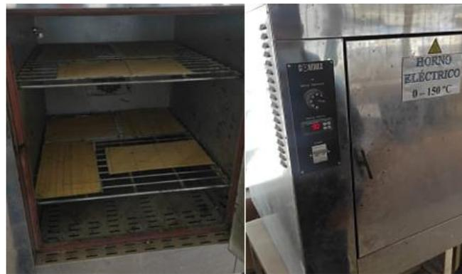
Figura 2.4. Curado de probetas en temperaturas de 60 °C, 90 °C y 120 °C.
