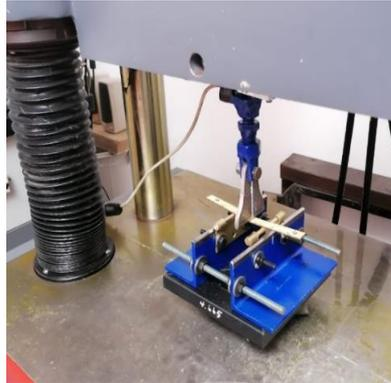
**Figura 2.8.** Ensayo de flexión en tres puntos simplemente apoyada.
