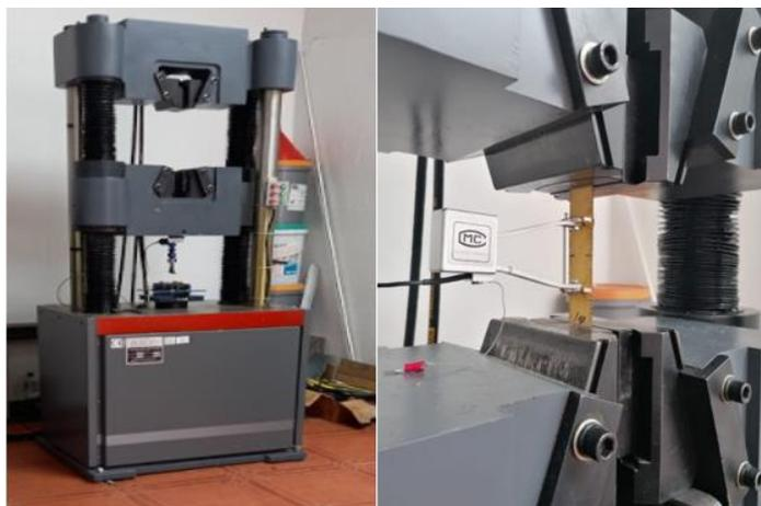
Figura 2.7. Máquina universal de ensayos de tracción WAW600B.
