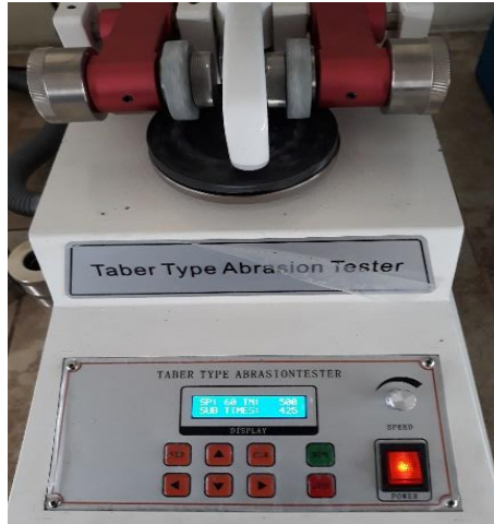
Figura 21: Proceso de desgaste abrasivo sobre una placa de ensayo.
