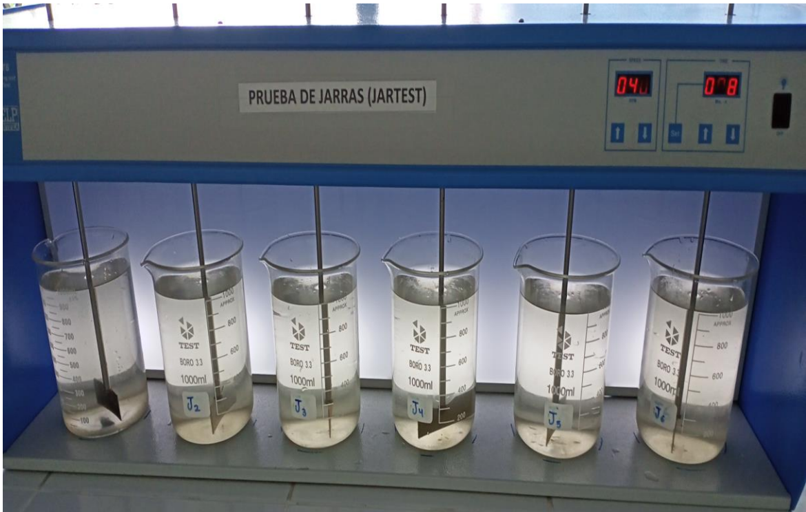
Figura 17: Equipo de la prueba de Jarras
