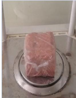
**Figura 3-13:** Probeta recubierta con material impermeable
