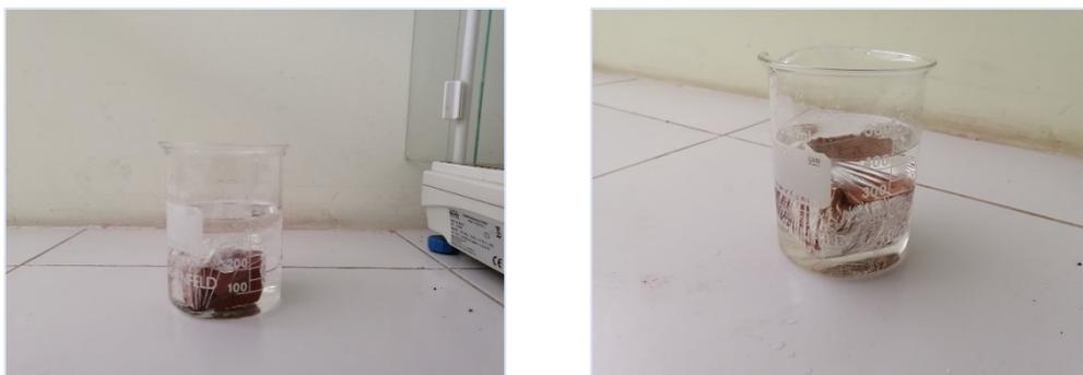
**Figura 3-12:** Muestras sumergidas en agua destilada.
