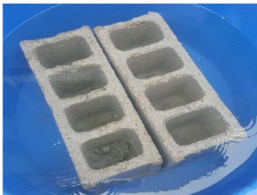
**Figura 3-16:** Muestras de bloques sumergidas en agua, para el cálculo de la densidad y porcentaje de absorción.
