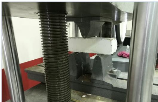
**Figura 3-18:** Punto de contacto de la máquina universal sobre probeta.
