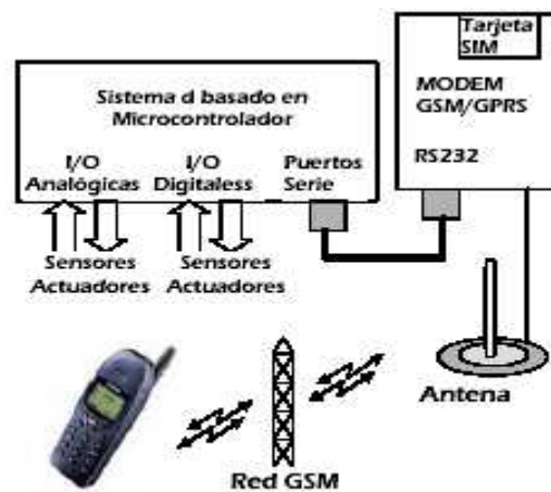
Figura 2.1.- Arquitectura Básica Sistema M2M.
