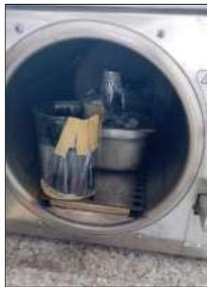
**Figura 8.-** Esterilización en autoclave.
