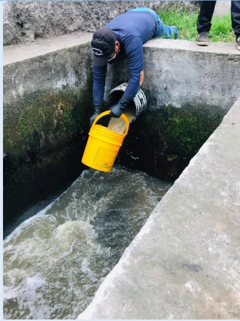
Toma de caudales en la 1er y 2da PTAR
