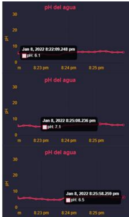
Figura 58 Datos del nivel de pH sensorizados
