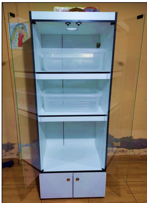
Figura 54 Estructura para el sistema acuapónico
