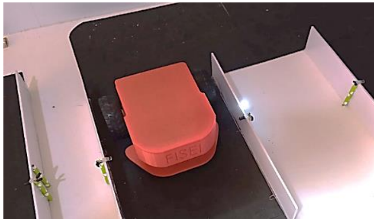
Figura N°- 60. Detección del robot en la pista con los sensores de presencia
