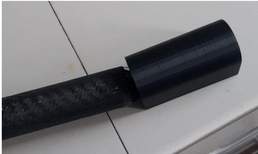
Figura 161 Acople de la cola del UAV
