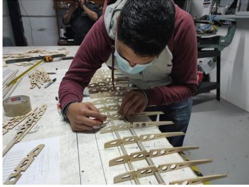
Figura 55 Colocación de las bases inferiores
