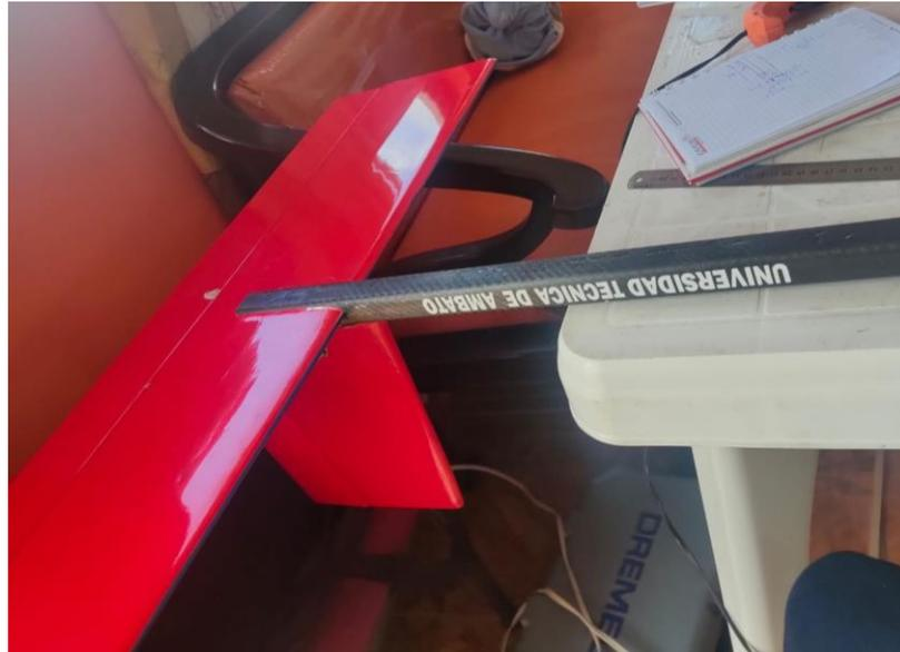
Figura 152 Cola tipo T del UAV
