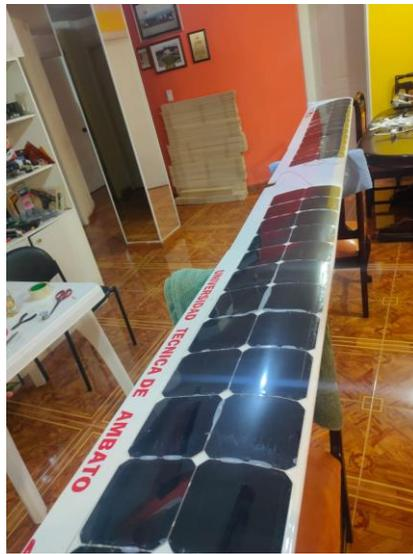
Figura 151 Colocación de los paneles solares en el UAV
