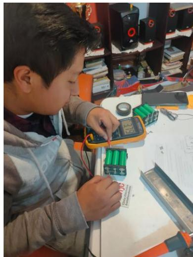
Figura 118 Comprobación del estado de las baterías
