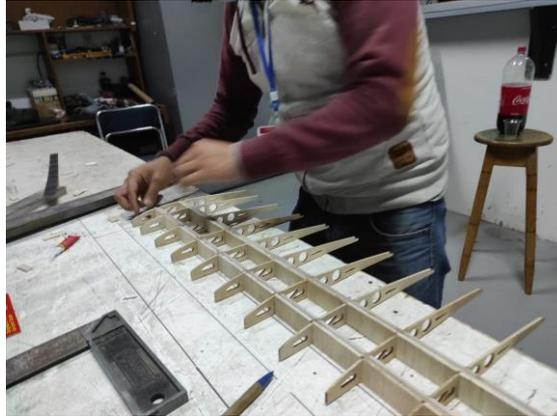
Figura 57 Colocación de bases pequeñas en uniones del ala
