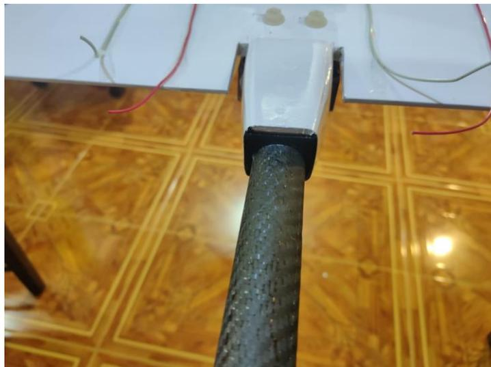
Figura 82 Acople de la cola con la cabina
