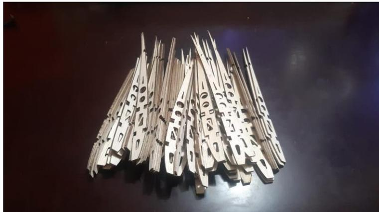
Figura 48 Conjunto de costillas que conformaran la estructura del ala
