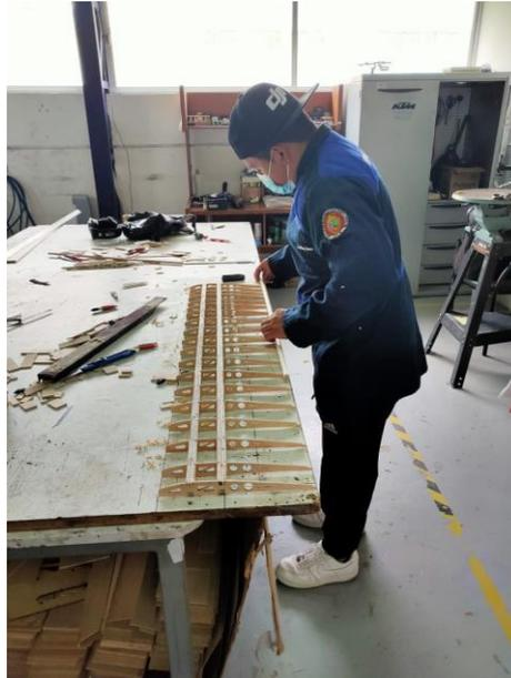
Figura 61 Colocación de base posterior de la costilla
