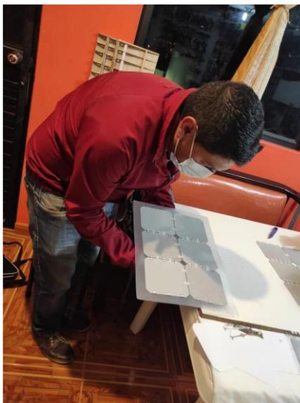
Figura 107 Proceso de emplasticar las celdas solares
