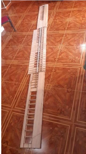
Figura 63 Colocación de recubrimiento con madera de balsa
