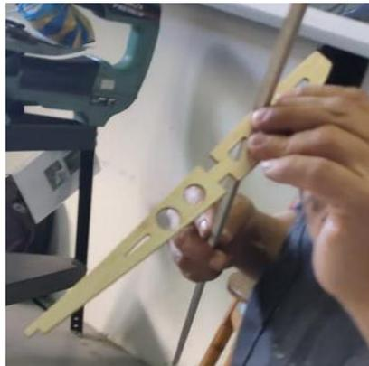
Figura 52 Colocación de las bases de las costillas
