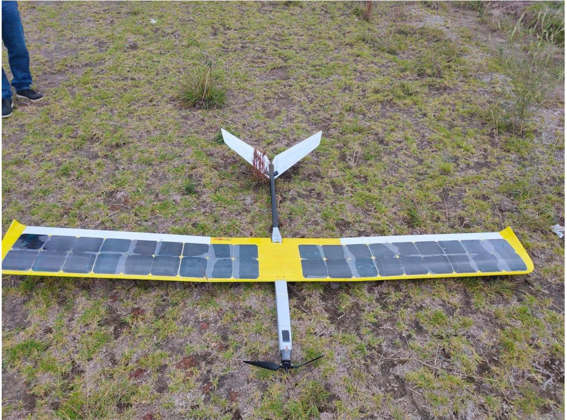
Figura 147 Prototipo UAV con simulación de peso de los paneles solares
