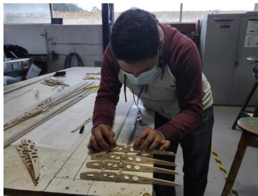
Figura 54 Colocación de las bases en la parte inferior de las costillas
