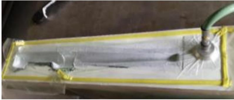
Figura 73 Succión al vacío para los componentes de la cabina
