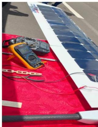
Figura 112 Medición de voltajes de un panel solar
