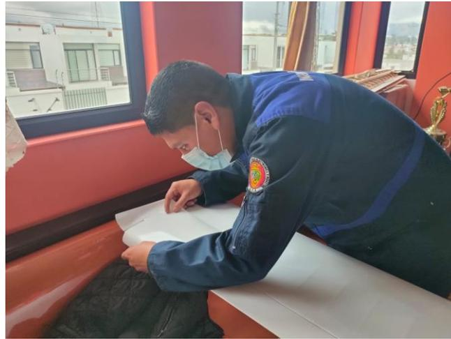
Figura 65 Colocación de Vinil adhesivo en el ala del UAV
