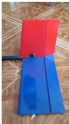
Figura 96 Colocación de alerones en los estabilizadores
