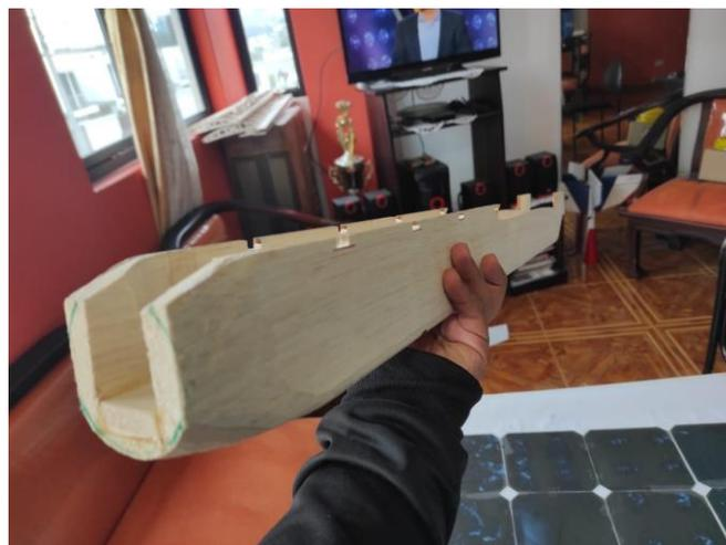
Figura 153 Modificación del tamaño de la cabina
