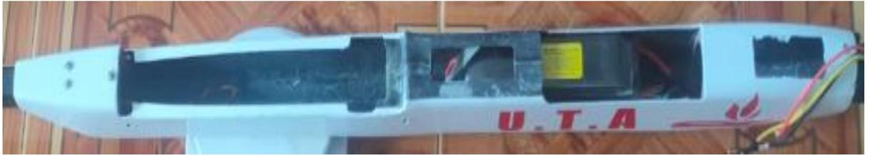
Figura 75 Corte de las superficies sobrantes de la cabina del UAV
