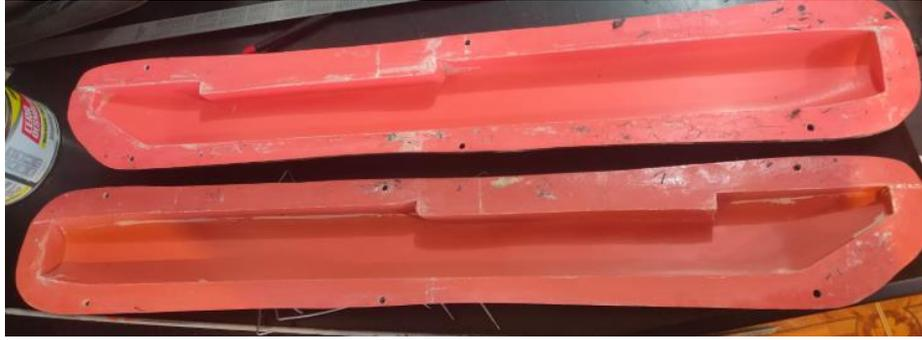
Figura 71 Molde para la cabina del UAV
