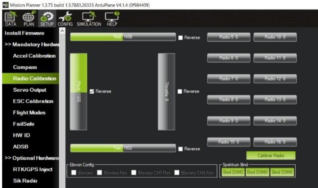
Figura 123 Valores de calibración de radio
