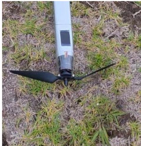
Figura 146 Colocación de una hélice plegable en el UAV
