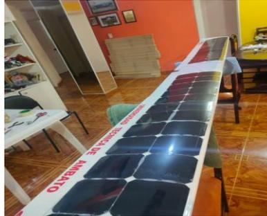
Figura 111 Colocación de los paneles solares en el ala
