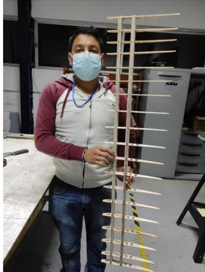
Figura 59 Estructura de la mitad izquierda del ala
