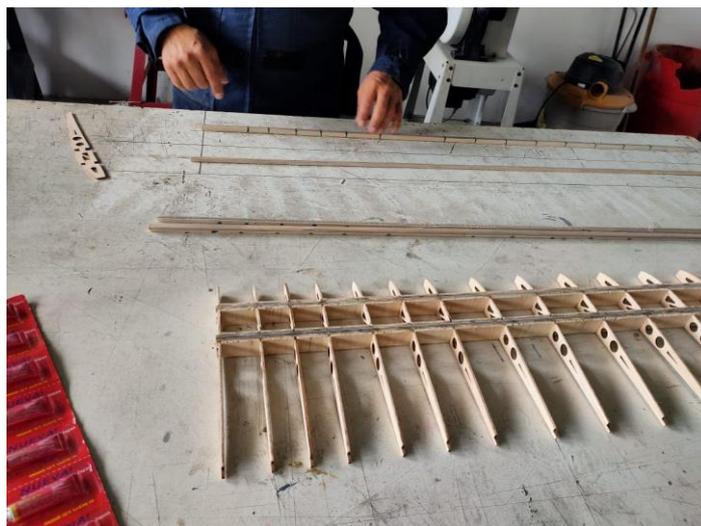
Figura 60 Construcción de la parte derecha de ala
