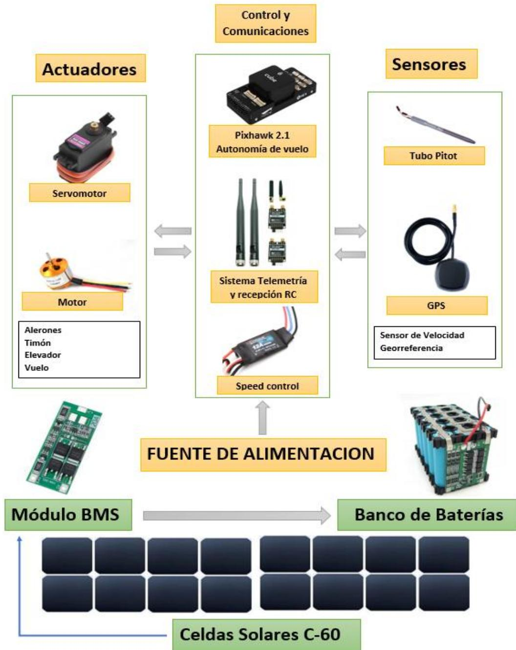
Figura 25 Esquema grafico general del UAV
