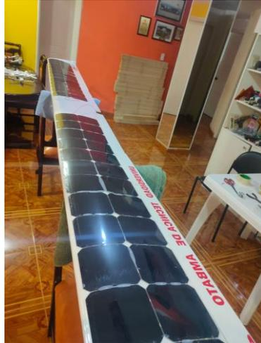
Figura 176 Paneles Solares en el ala
