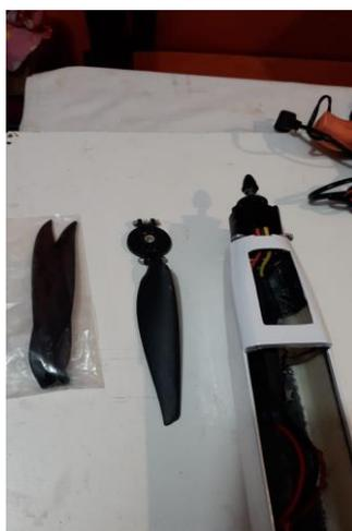
Figura 158 Acoplamiento de hélice plegable
