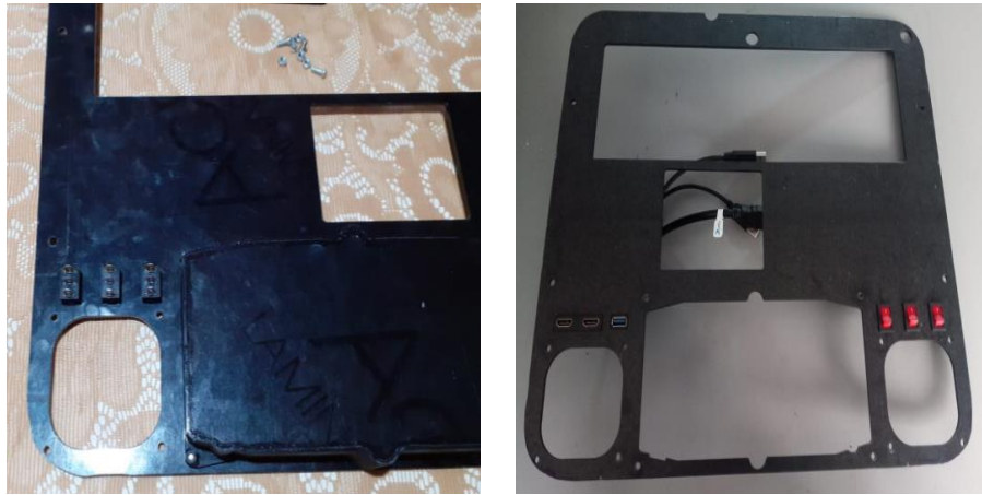
Ilustración 51 Ubicación de switch de Energización.
