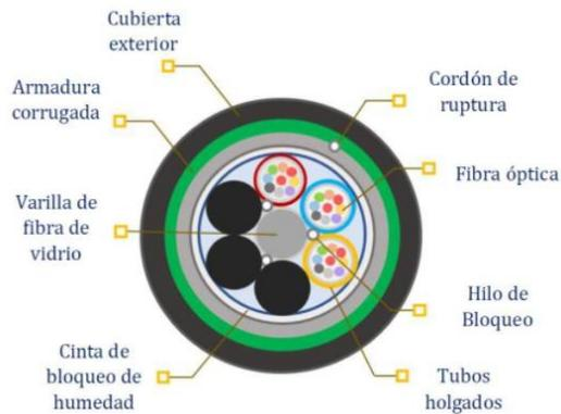
**Figura 25** Cable Armado [28]
