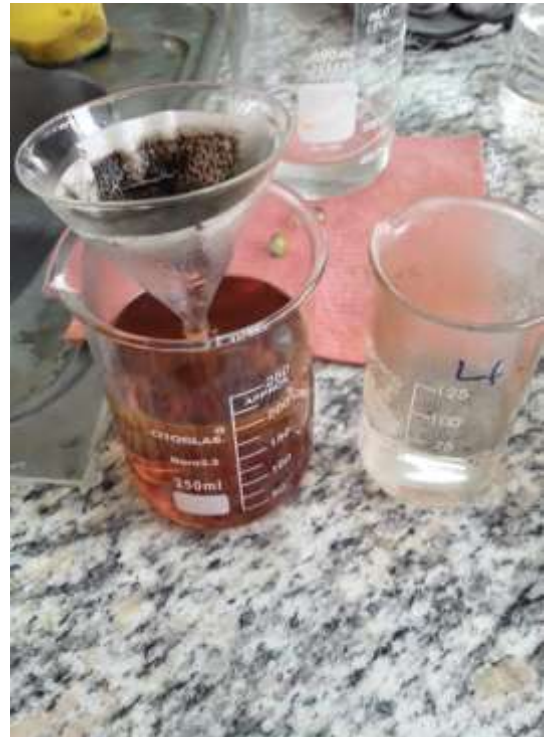
Figura 37. Filtración y lavado de la muestra
