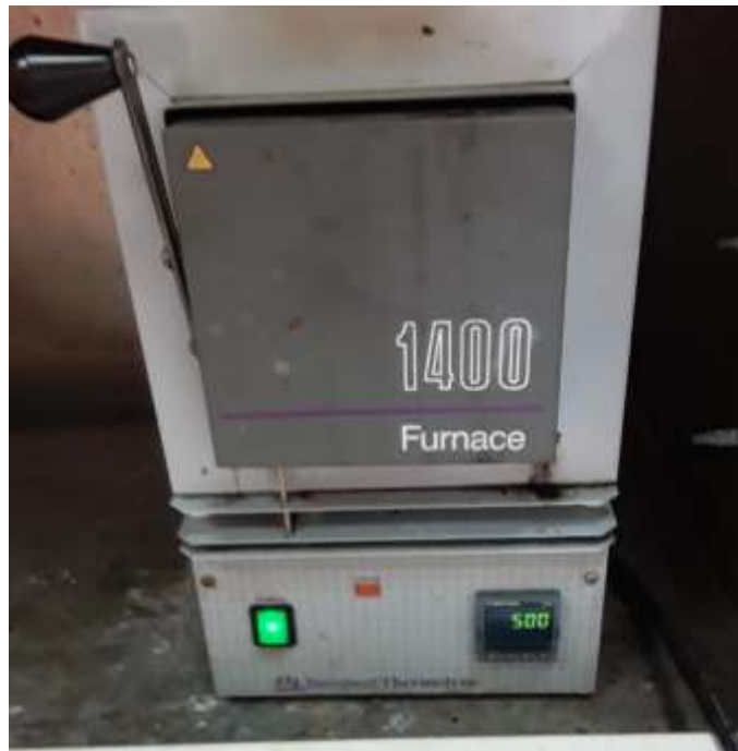
Figura 31. Incineración de la muestra en la mufla
