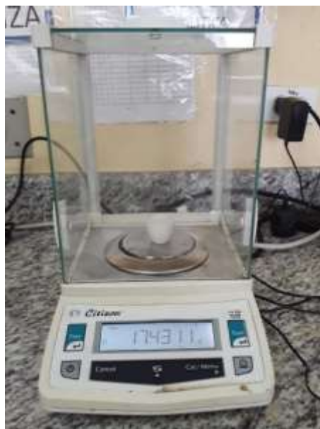
Figura 29. Pesado del crisol + la muestra
