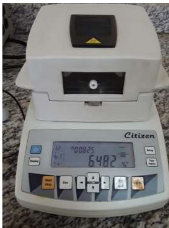
Figura 32. Balanza de humedad
