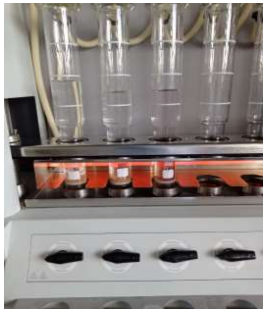
Figura 41. Extracción de fibra
