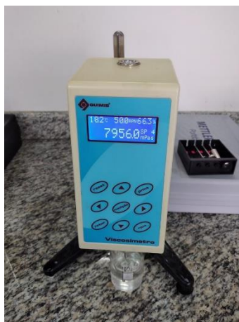
Figura 5. Viscosímetro rotacional QUIMIS utilizado para la medición de la viscosidad.
