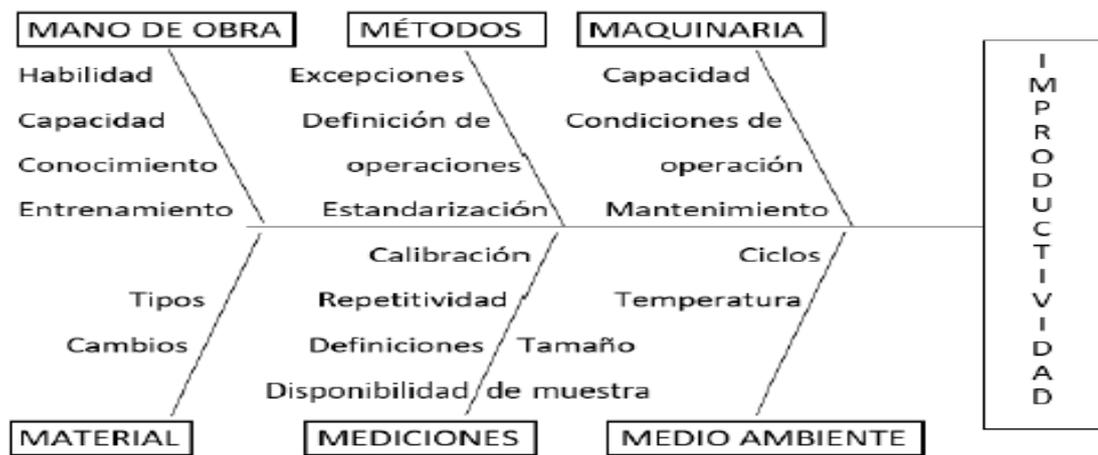
Figura 11: Diagrama de Ishikawa aplicado para determinar la causa del problema de Producción [14].
