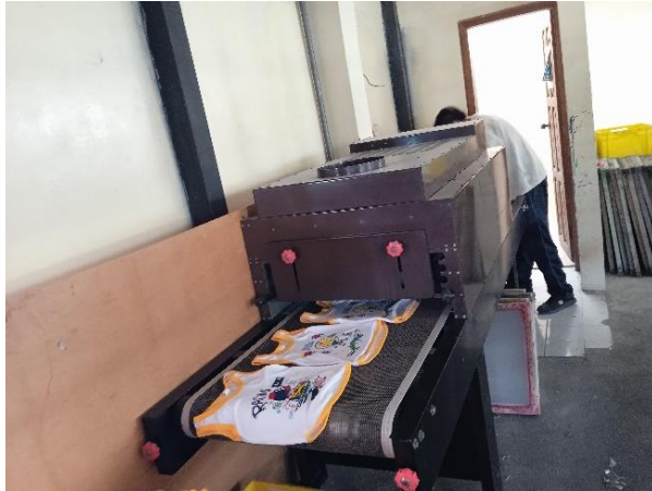
Figura 10: Prendas en el Horno Termo Fijador
