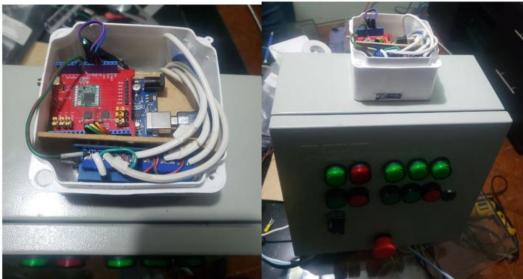
**Fig. 62. Dispositivo nodo actuador ensamblado**
