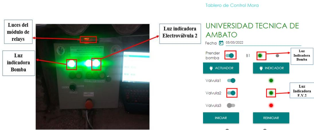
**Fig. 74. Encendido – Electroválvula 2**
