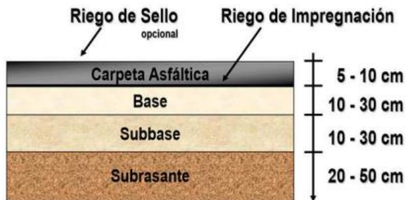
Figura N°17 Estructura de un pavimento flexible.
