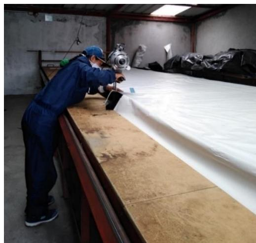
**Figura 7** Corte de los moldes para su posterior confección mediante una cortadora modelo KM MACK
