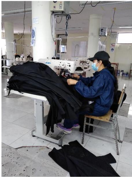
**Figura 8** Armado de los diferentes modelos de los pantalones haciendo uso de máquinas rectas y overlock marca JUKI
