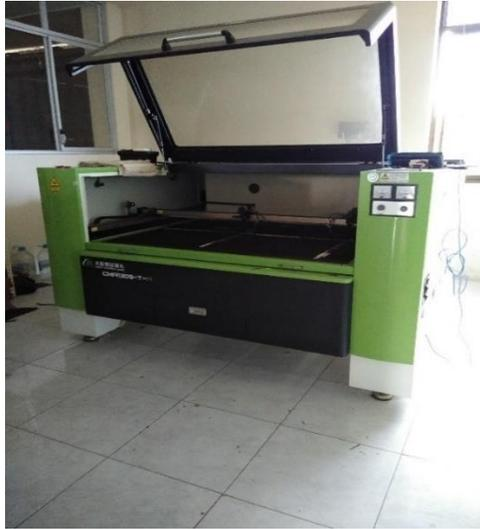
**Figura 11** Máquina de grabado y corte láser para realización de etiquetas modelo Yueming CMA 1309-T-A
