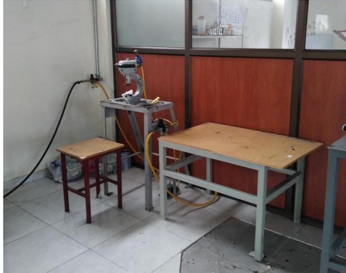
**Figura 9** Remachadoras para pegado de broches y botones, trabajo mediante aire comprimido
