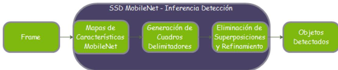
Figura 17. Funcionamiento general sistema de detección con SSD MobileNet (Autor).
