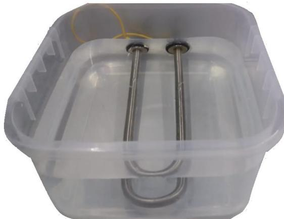
Figura 4-34: Sistema de humidificación
