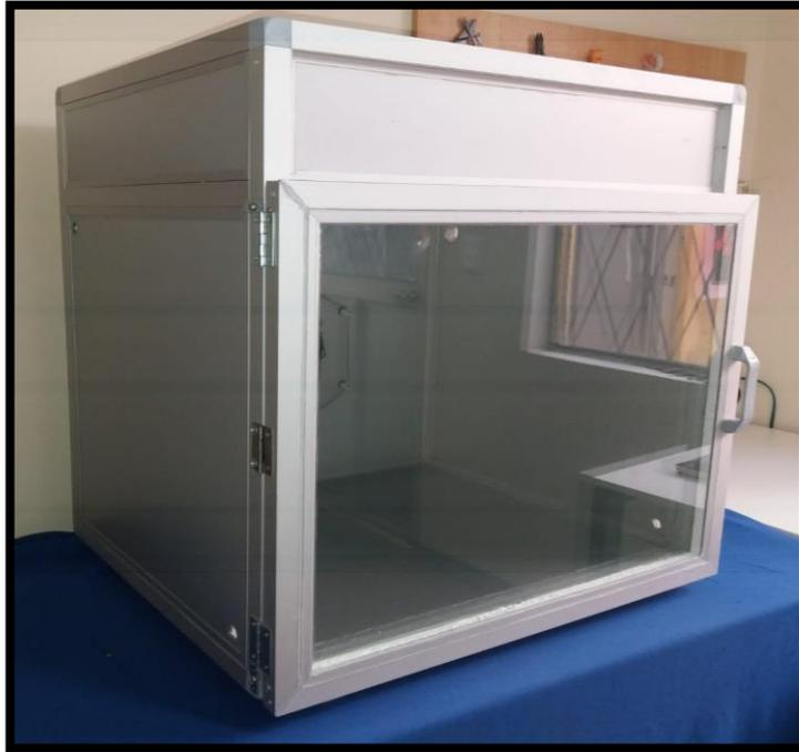
Figura 4-2: Fotografía del módulo de incubación
