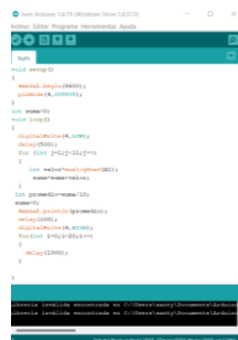
Figura 4-37 Programación para pruebas de los sensores de humedad
