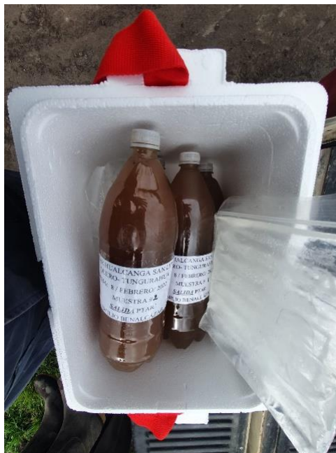
Figura 15. Identificación y conservación de las muestras de las aguas residuales tomadas en la PTAR de Hualcanga San Luis.
