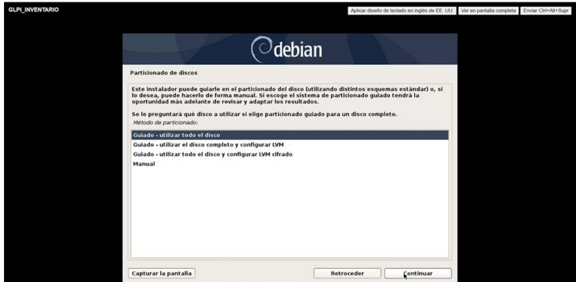
Figura 48. Subtarea particionamiento disco guiado
