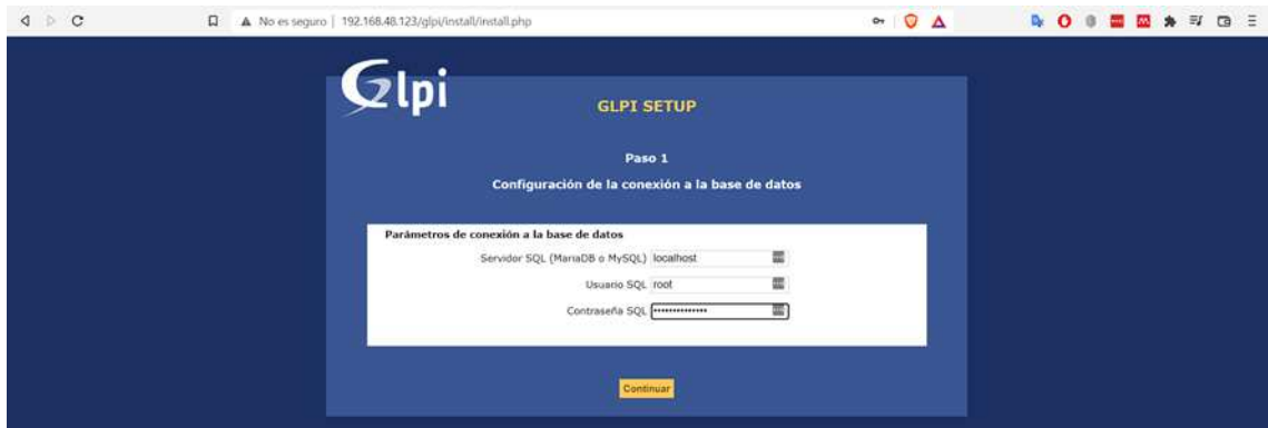
Figura 95. Conexión a la base de datos
