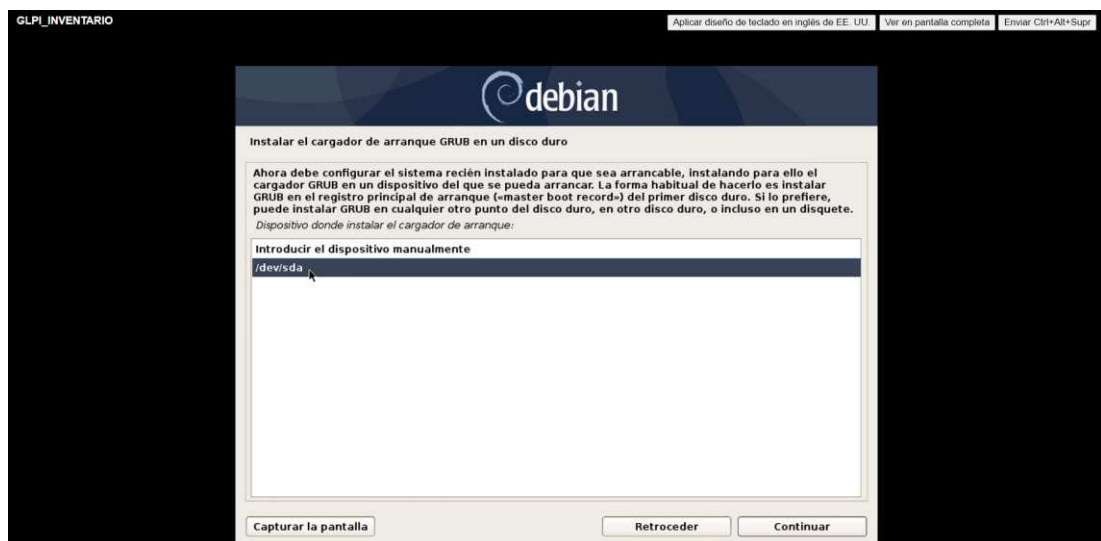
Figura 56. Instalación cargadora de arranque GRUB disco duro
