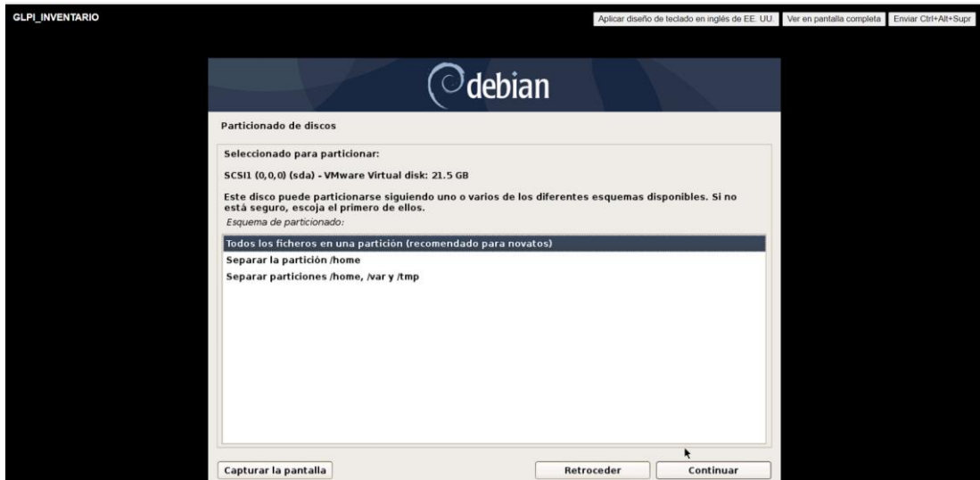
Figura 50. Instalación de Ficheros en la partición
