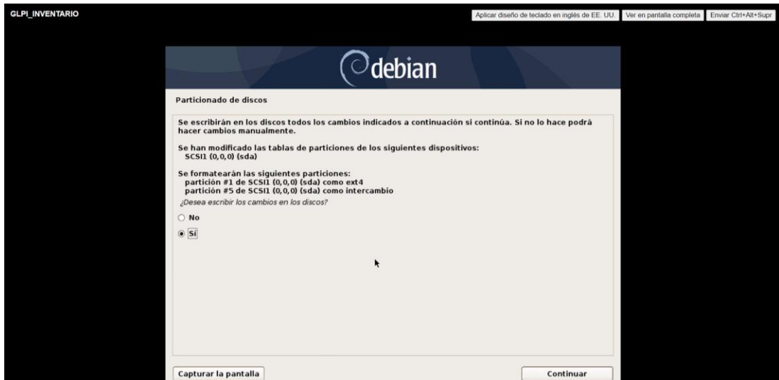
Figura 52. Sobreescritura del disco para instalación
