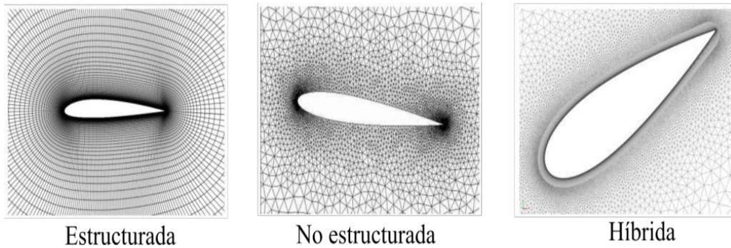
**Figura 8:** Mallas estructuradas, no estructurada e híbrida [43].
