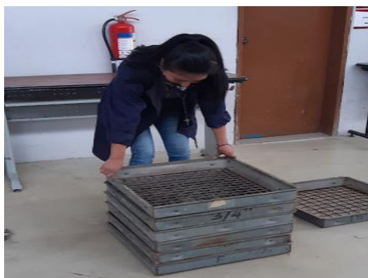
Tamizado de las muestras para el análisis granulométrico.
