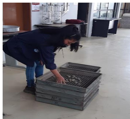
Tamizado de las muestras para el análisis granulométrico.
