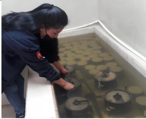
Muestras sumergidas en el cuarto de curado y sacadas después de 24 horas.
