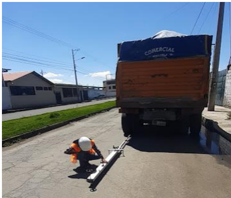
Aplicación de la viga Benkelman y registro de temperatura de la calzada.
