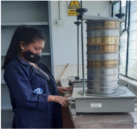
Tamizado de las muestras para los ensayos de límite líquido y plástico
