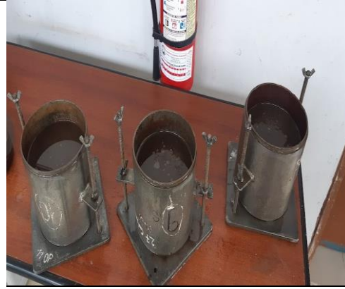
Muestras sumergidas en el cuarto de curado y sacadas después de 24 horas.
