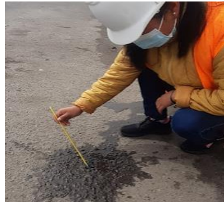
Aplicación de la viga Benkelman y registro de temperatura de la calzada.
