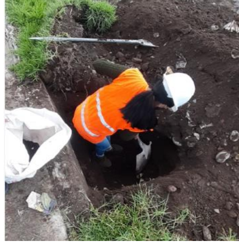
Excavación y recolección de muestras de suelo.
