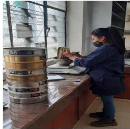
Tamizado de las muestras para los ensayos de límite líquido y plástico
