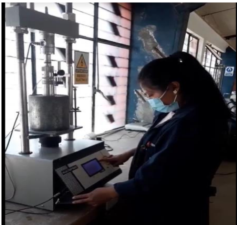
Lectura de valores arrojadas por la máquina del ensayo CBR y muestras tomadas de la parte superior e inferior para llevarlas al horno
