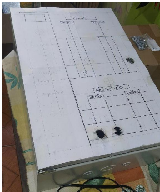
Figura 48 Dimensionamiento del tablero de control
