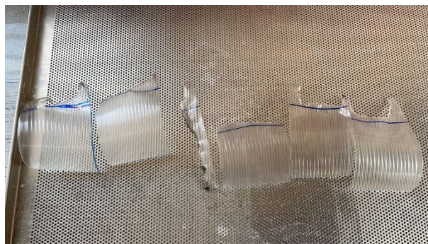
Figura 32: Ensayo de inflamabilidad vaso plástico Polipropileno.
