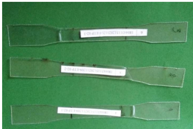
Figura 36: Probeta de ensayos de tracción en polipropileno.
