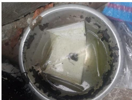
Figura 34: Muestra de plástico de polipropileno y plástico vegetal con base en almidón de maíz en agua estancada.
