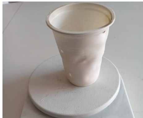
Figura 46: Molde y vaso obtenidos.
