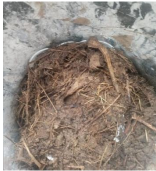
Figura 33: Muestra de plástico de polipropileno y plástico vegetal con base en almidón de maíz en compostaje.
