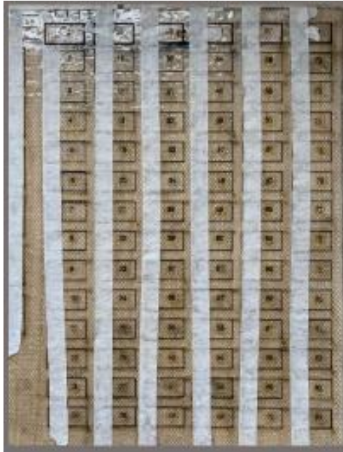
Figura 32: Lámina del material compuesto (resina poliéster + fibra de cabuya).
