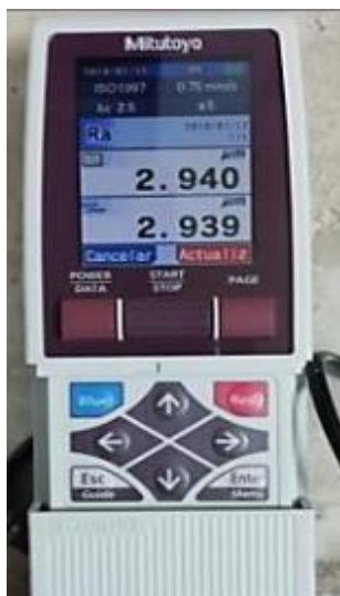
Figura 30: Calibración del equipo Rugosímetro digital MITUTOYO SurfTest SJ-210.
