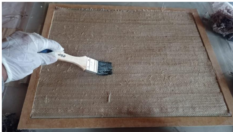
Figura 27: Fabricación de la plancha del material estratificado de forma manual.
