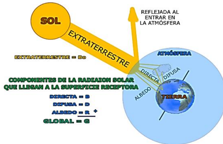
Figura 2-1: Interacción de la radiación solar con la atmósfera terrestre Fuente: (Acosta Castiblanco, 2021)
