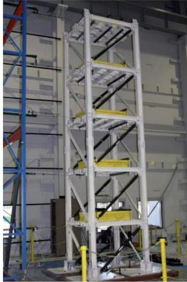
**Fuente:** Prueba de simulador de terremoto en estructura de cinco pisos con sistema de amortiguamiento viscoso. [13]
