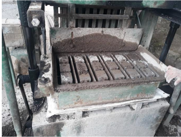
Moldes de bloques.
