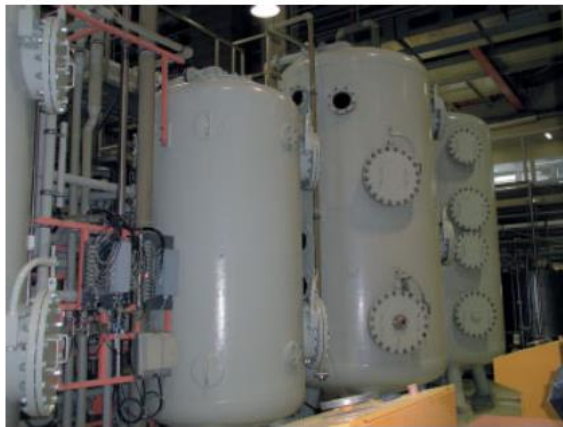
Figura 7: Los intercambiadores de iones en columnas grandes eliminan específicamente los cationes o aniones o desionizar la solución de gelatina por completo. [6]
