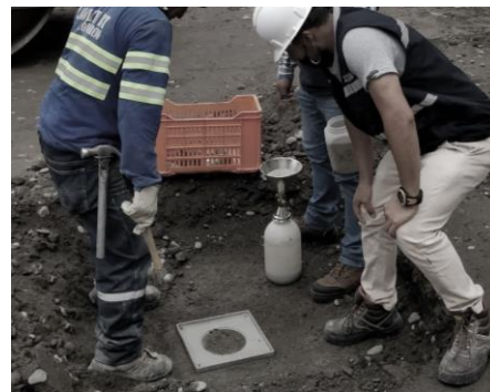
Ensayo in situ de cono y arena.
