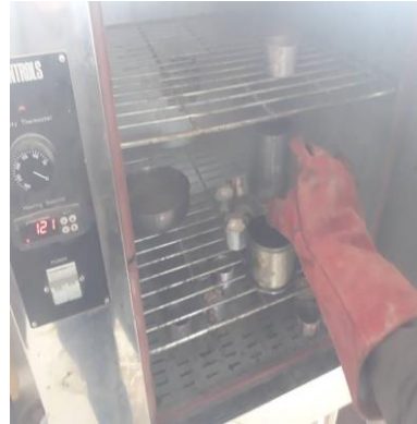
Secado de muestras en horno, tomadas desde el molde.
