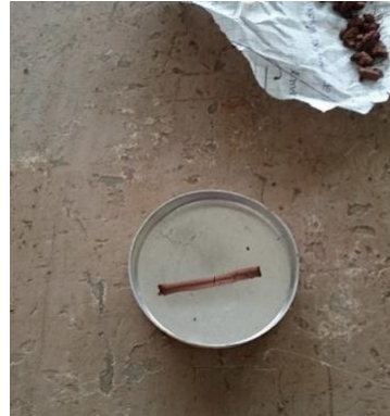
Identificación de rollos para ensayo de límite plástico.
