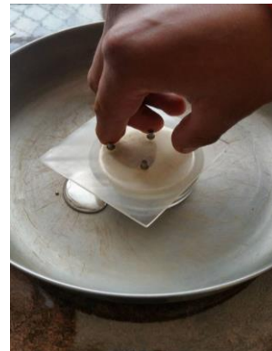
Retiro de excedente de mercurio con la placa tripi.
