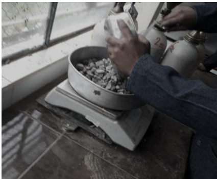
Determinación de peso de suelo tamizado.
