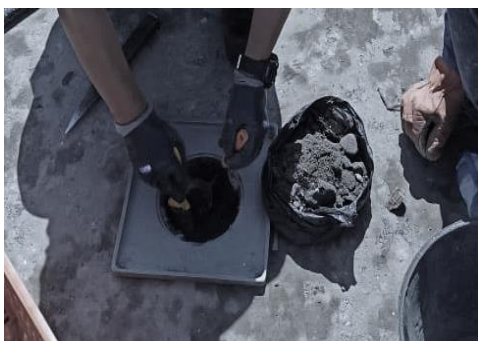
Recolección de suelo en ensayo de densidad de campo.
