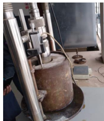
Aplicación de carga sobre pistón de penetración mediante prensa CBR.
