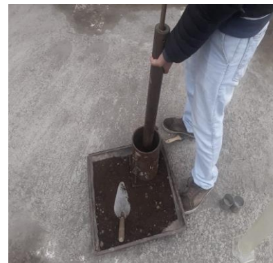
Compactación de suelo en molde.
