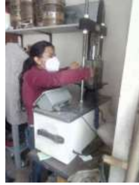
CBR – Colocación del molde cilíndrico en la máquina CBR
