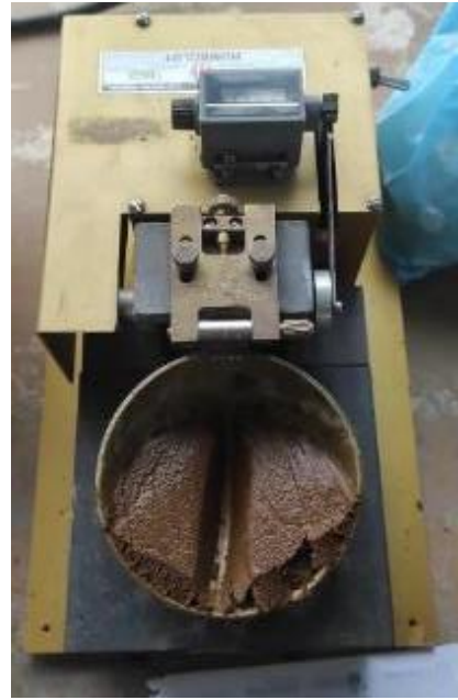
Compresión de suelo para ensayo de proctor
