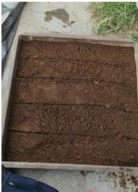
Cuarteo de muestra para ensayo de proctor
