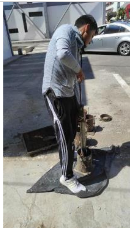
Compresión de suelo para ensayo de CBR
