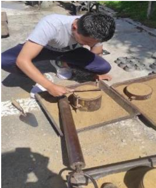
Rasanteo de cilindro para ensayo de proctor
