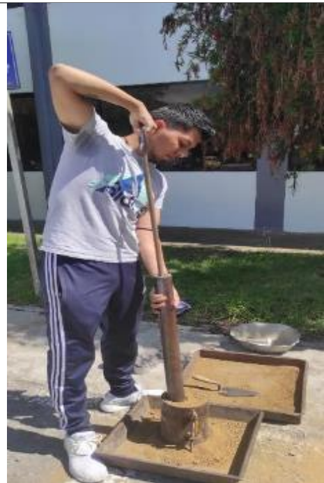
Compresión de suelo para ensayo de proctor
