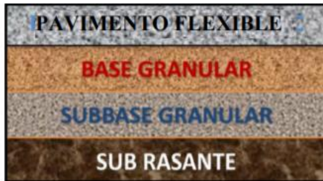
Figura 22. Estructura del pavimento flexible
