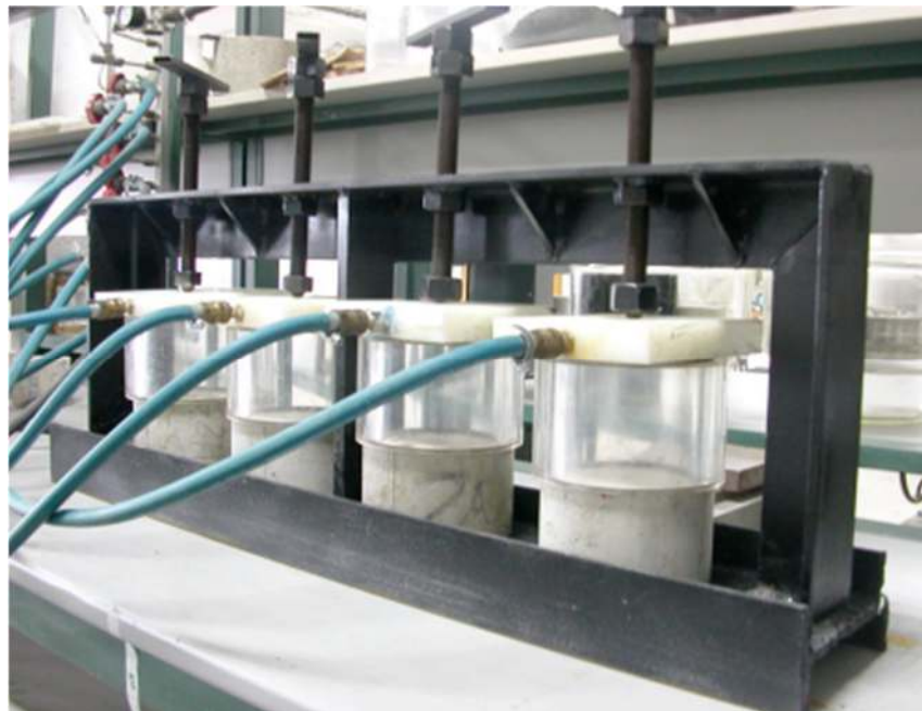
Figura 22. Ensayo de penetración de agua bajo presión[75].
