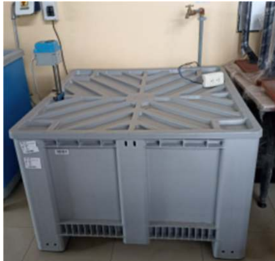
Figura 24. Tanque de curado.
