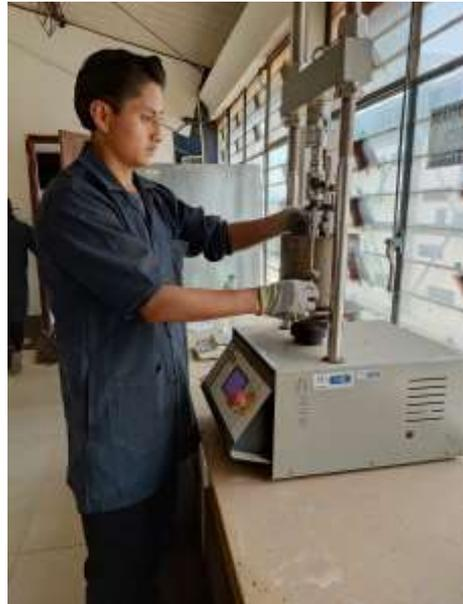
Ensayo de Carga de Penetración
