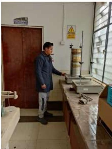
Realizando el Ensayo Granulométrico en los Laboratorios FICM
