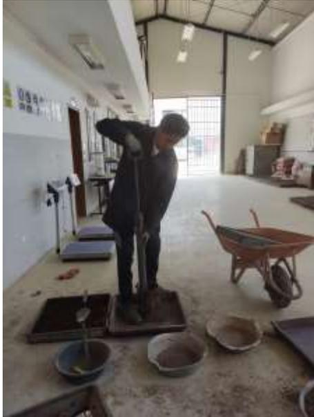
Ejecución del Ensayo de Compactación
