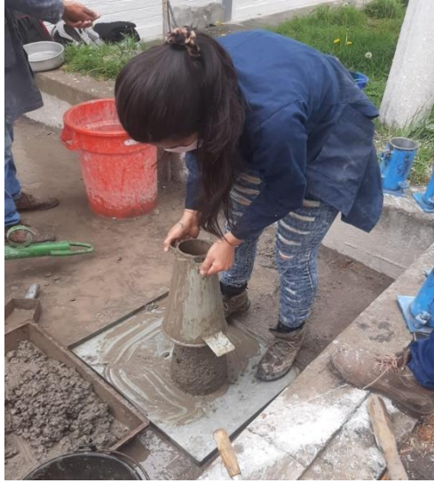
Fotografía 36.- Ensayo de asentamiento del hormigón con el cono de Abrams, levantamiento del molde.
