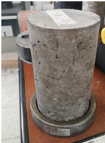
Fotografía 46.- Esquema de falla del hormigón.
