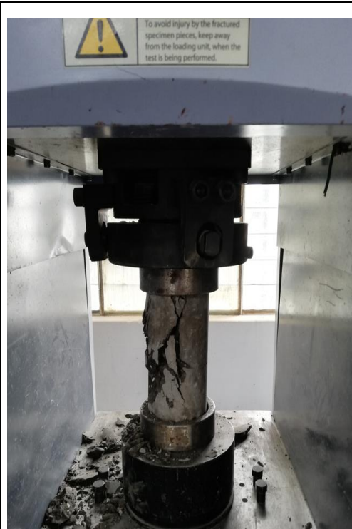
Fotografía 45.- Ensayo a compresión del hormigón.
