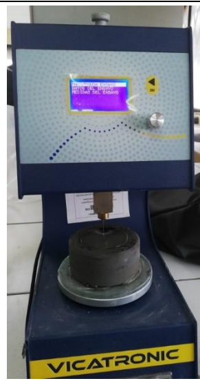
Fotografía 16.- Ensayo de tiempo de fraguado de la pasta de cemento en el Aparato automático de Vicat.
