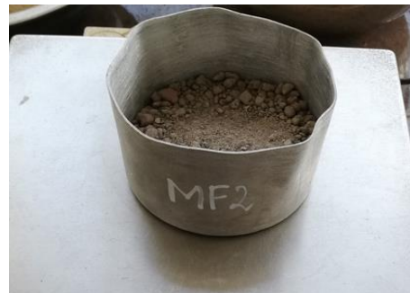
Fotografía 6.- Contenido de Humedad del agregado fino.
