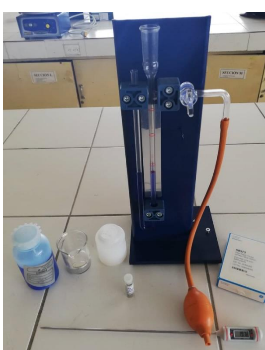
Fotografía 17.- Preparación del equipo de Blaine para el ensayo de finura del cemento y la ceniza.
