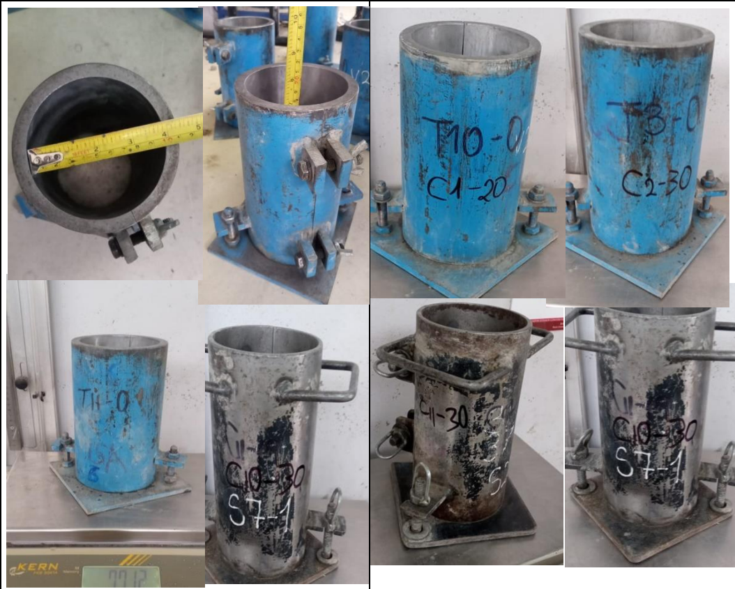
Fotografía 25.- Cilindros metálicos de 10 cm de diámetro y 20 cm de altura.
