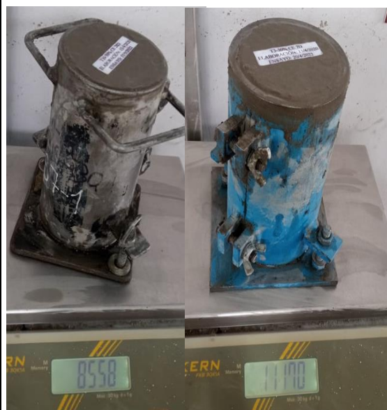
Fotografía 39.- Registro de pesos de cilindros de hormigón fresco.
