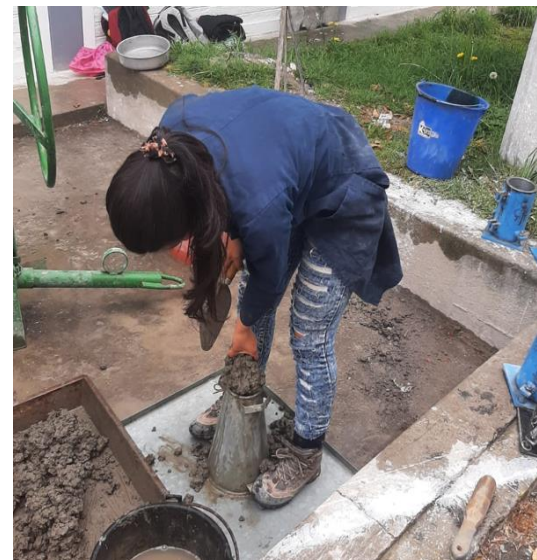
Fotografía 35.- Ensayo de asentamiento del hormigón con el cono de Abrams, vertido de hormigón.
