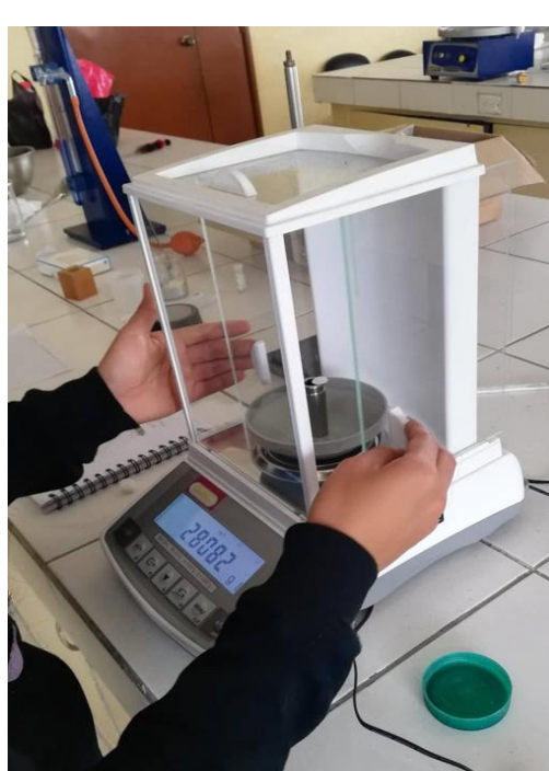
Fotografía 18.- Colocación de la cápsula de permeabilidad para calibración del equipo de Blaine.
