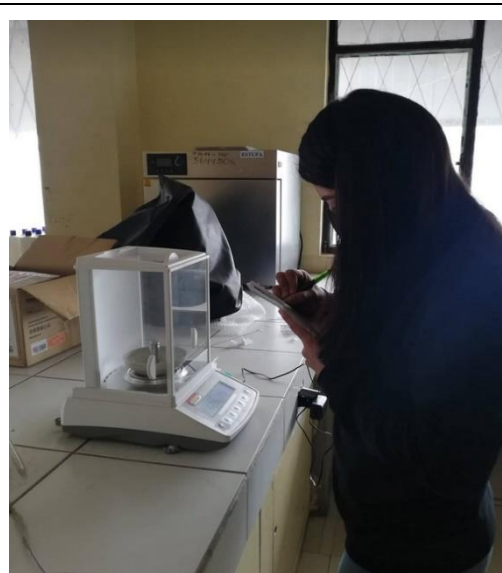
Fotografía 20.- Registro del peso de la capsula de permeabilidad más cemento.
