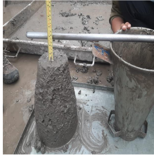
Fotografía 37.- Ensayo de asentamiento del hormigón con el cono de Abrams, medición y registro del asentamiento.
