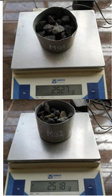
Fotografía 8.- Capacidad de absorción del agregado grueso.
