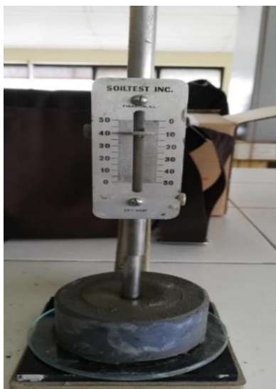
Fotografía 15.- Obtención de la consistencia normal de la pasta de cemento para tiempo de fraguado.
