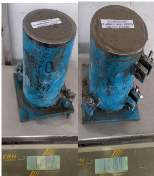
Fotografía 38.- Registro de pesos de cilindros de hormigón fresco.
