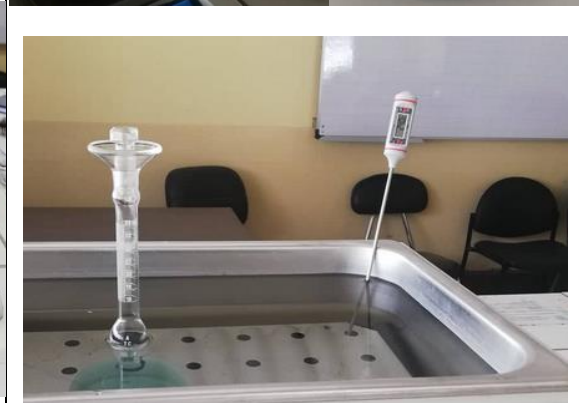
Fotografía 14.- Densidad real de la ceniza. Método Le Chatelier.
