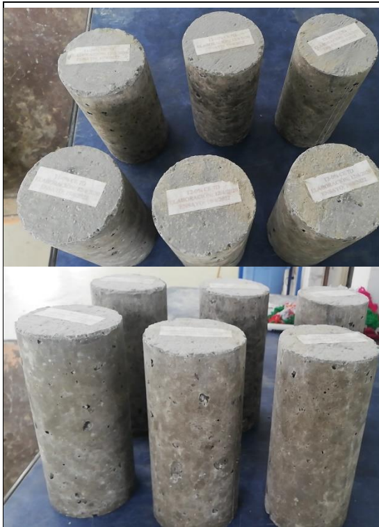
Fotografía 44.- Preparación de los cilindros de hormigón, para el ensayo a compresión.
