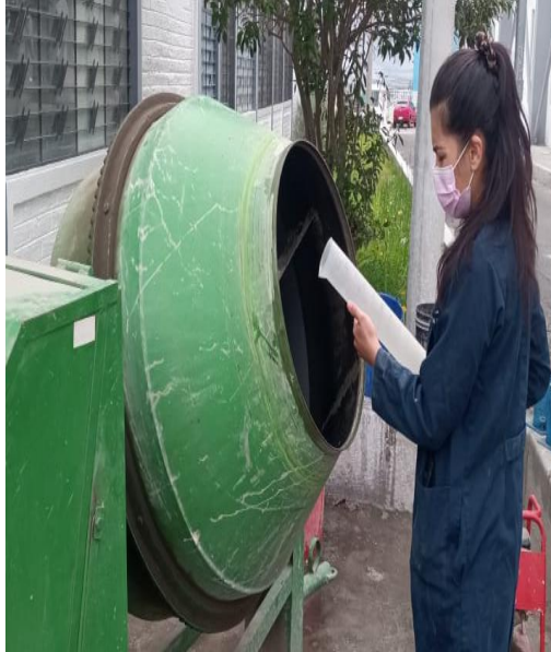
Fotografía 32.- Colocación del agua de amasado.
