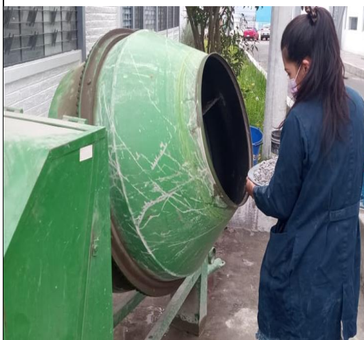
Fotografía 30.- Colocación del agregado grueso en la mezcla de concreto.
