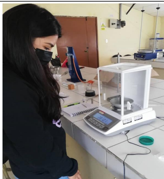
Fotografía 19.- Pesaje de la capsula de permeabilidad con mercurio.
