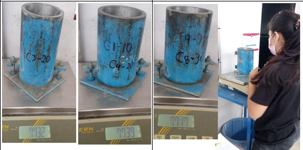
Fotografía 27.- Pesaje y registro de los cilindros metálicos para hormigón con 20% de ceniza.
