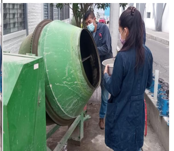
Fotografía 31.- Colocación del cemento en la mezcla de concreto.
